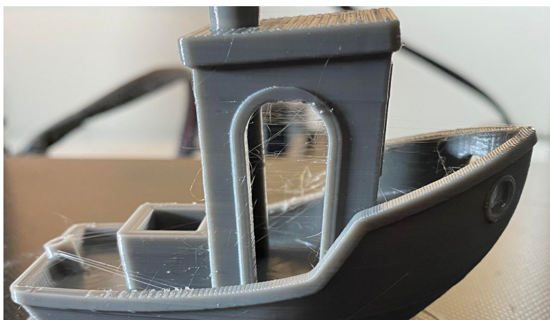
Obrázek 2.3: Lehké stringování na vytisknuté lodičce. Převzato z příspěvku na webovém fóru reddit [15].
