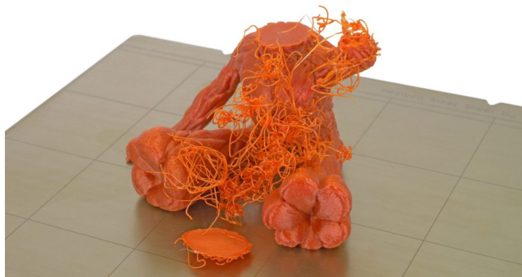
Obrázek 2.2: Příklad chyby špagety. Převzato z fóra Prusa3D [5].
